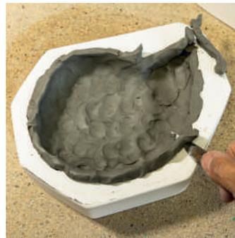
**3** Schneiden Sie die Kante bündig ab, ohne die Form zu beschädigen (evtl. mit einem Modellierholz).
