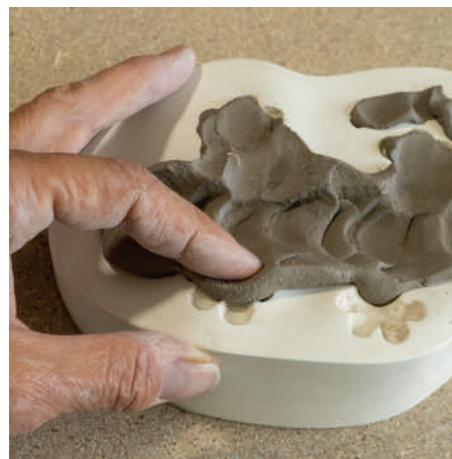
**3** Schieben Sie den Ton aus der Mitte bis in alle Teile der Form (so vermeiden Sie Nähte).
