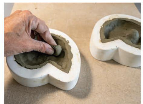
**6** In lederhartem Zustand entformen Sie die Hälften, indem Sie einen feuchten Tonklumpen abwechselnd aufdrücken und hochziehen.
