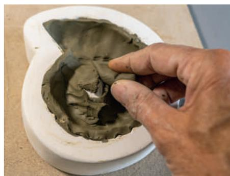
**5** Mit einem Tonklumpen füllen Sie die fehlenden Stellen wieder auf und drücken alles gut an. Dann schneiden Sie wieder den Tonrand vorsichtig und gerade entlang der Formkante ab.
