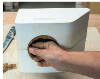
**7** ... verbinden Sie die beiden Formhälften. Drücken Sie den Ton fest auf die innere Naht und versäubern sie.
