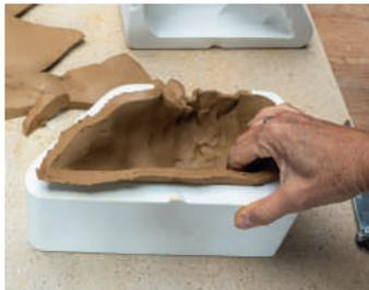
**1** Drücken Sie ca. 8mm dicke Tonplatten gleichmäßig in die Form.
